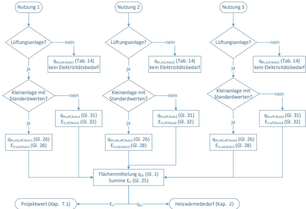
Abb. 5 Flussdiagramm Berechnung wirksame Aussenluftvolumenströme und Elektrizitätsbedarf.
